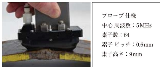
図8 溶接供試体へのアダプティブ FMC/TFM
