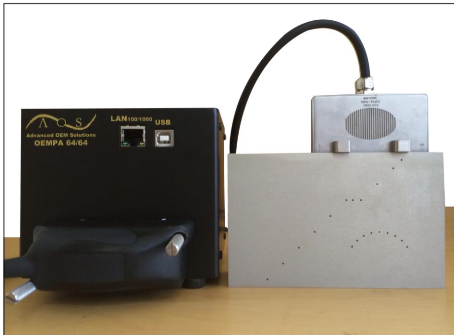
図5 超音波探傷装置、アレイ型探触子及びアルミニウム合金製テストブロック
