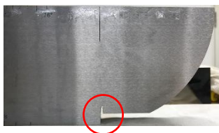
板厚 100mm 方向にある、高さ 15mm、幅 2mm のスリット
