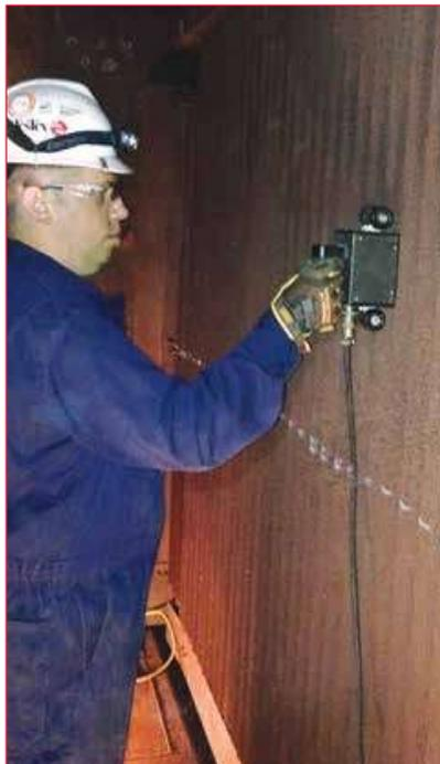
低周波電磁誘導技術 (LFET) スキャナーを使用します。(上図)。LFET スキャナーは、フィンを通してチューブのきずを検出し、定量化できます。これにより、孔食や流れ加速型腐食などの一般的な減肉を探傷することができます。
